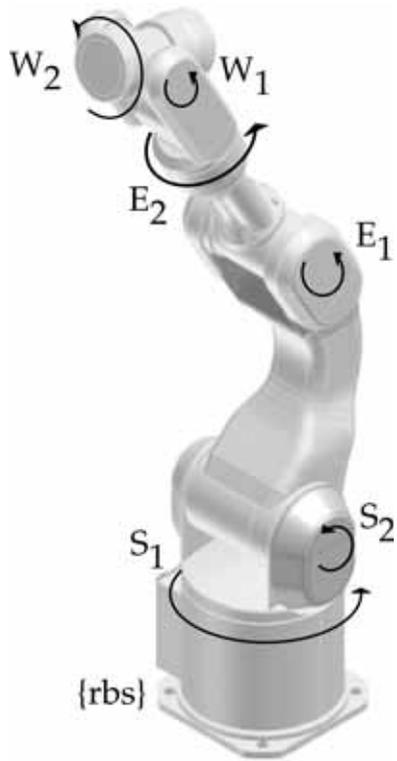
Abbildung 2: Robotergelenke (MHI PA10-6C)
